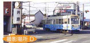
「井原」電停と「運動公園前」電停の間には、半径11mという日本の鉄道・軌道の中で一番急なカーブ(井原交差点)があります。
