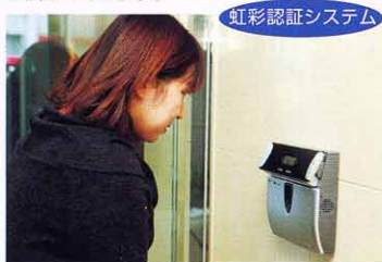
虹彩認証は、他人受入率120万分の1以下という精度で本人確認をするバイオメトリクス（生体認証）。
