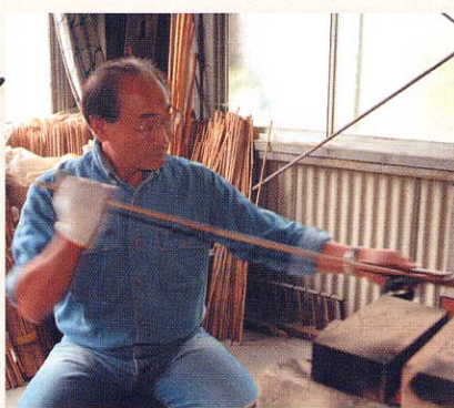
竹を火であぶり、内部の水分を飛ばしていく。竹は少しずつ矯正されながら軽くなっていく。作業所の道具も鈴木さんの手作り。
